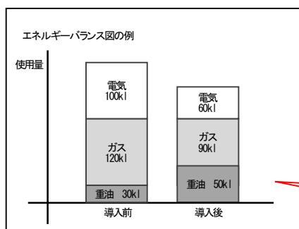
電気・ガス・重油など複数（3種以上）のエネルギーの増減がある事業、あるいはプラントなどのエネルギーの動きが複雑である事業等は、エネルギーバランス図やエネルギーフロー図を記載もしくは別図として添付する。
