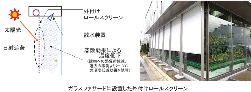
ガラスファサードに設置した外付けロールスクリーン
